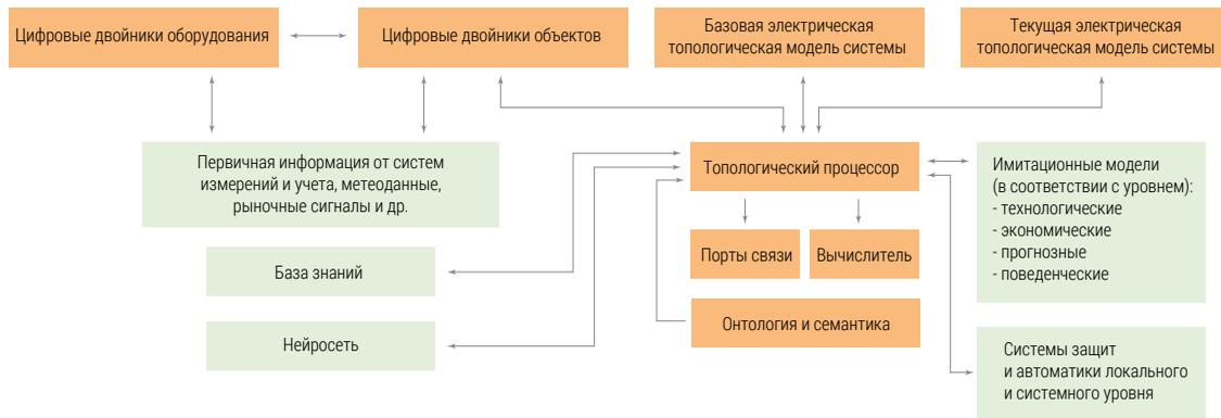
Рис. 2. Топологический процессор и его информационная среда
