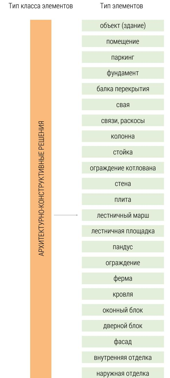
Рис. 1. Классификация требований к информационной модели объекта капитального строительства
