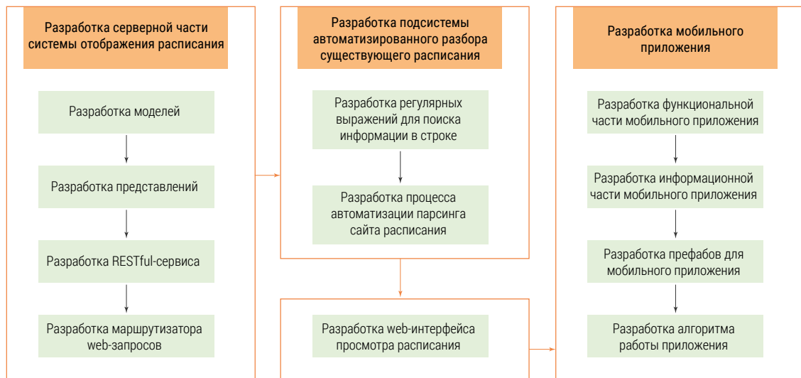
Рис. 2. Этапы разработки компонентов автоматизированной системы
