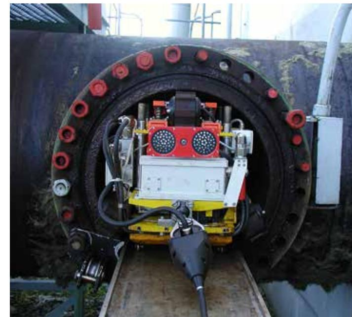
Внутритрубная дефектоскопия с использованием ИИ
