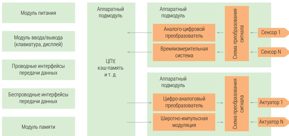
Рис. 2. Общая схема устройства промышленного Интернета вещей.
